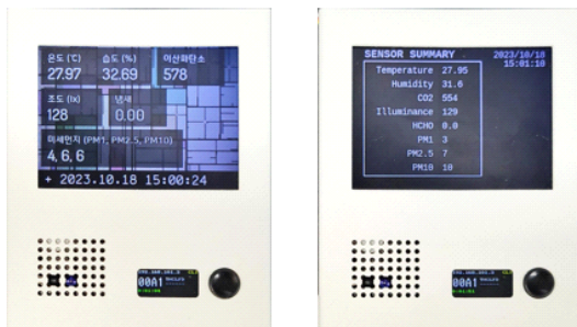
그림 2. 복합 환경센서 장치 Fig. 2. Complex environmental sensor device
